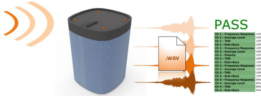
图 14: 使用 KLIPPEL QC 系统基于 wav 文件测试的智能音箱 4 个麦克风响应
