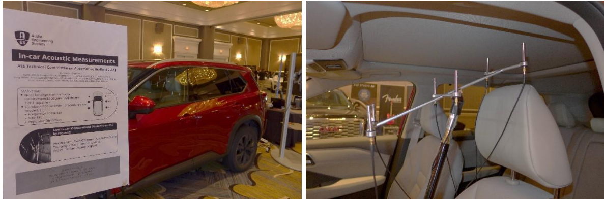
图 4+5:2022 年 7 月的底特律 AES 汽车音频大会上使用麦克风阵列进行车厢声学测试的设置
